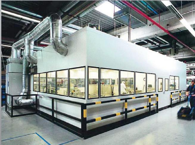
“Reinraum in Raum”-Installation für die Fertigung von medizintechnischen Produkten in einem Kunststoff verarbeitenden Betrieb.
