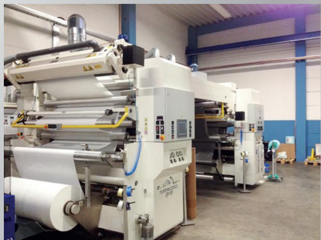
*Linienabsaugung an Folienkaschieranlagen als zonenspezifischer Schutz bei gleichzeitiger turbulenzarmer Frischluftzufuhr.*
