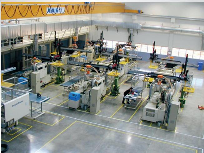
Blick auf einen Teilbereich einer Spritzgießfertigung mit Zuluftverteilung über Verdrängungsluftauslässe.
