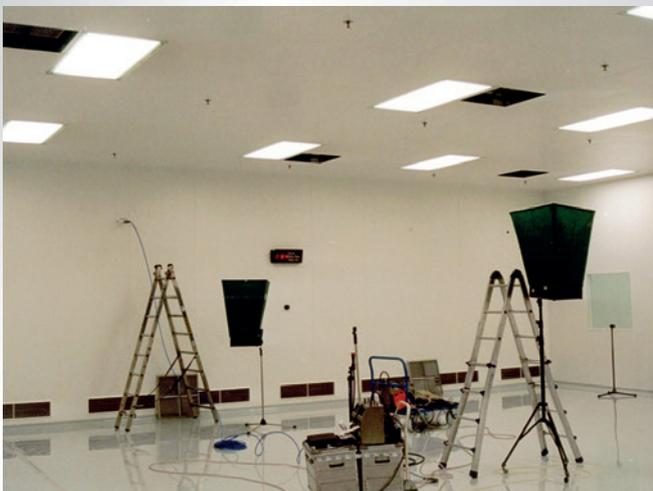
Aufbau einer Messanordnung zur Überprüfung der Reinraumklassifizierung in einem Kunststoff verarbeitenden Betrieb.
