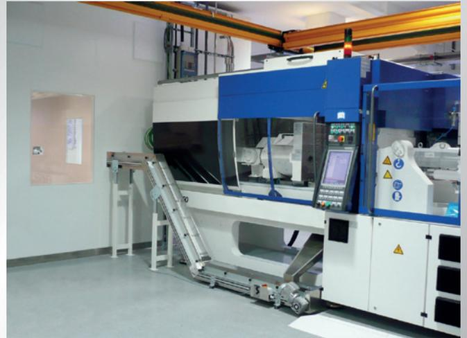
Beispiel für eine Produktion von Kunststoffteilen, mit Transporteinheit und nachgelagertem Verpackungshandling unter Reinraumbedingungen (Reinraum Klasse ISO 7 (10.000), Maschinenaufstellung im Grauraum).
