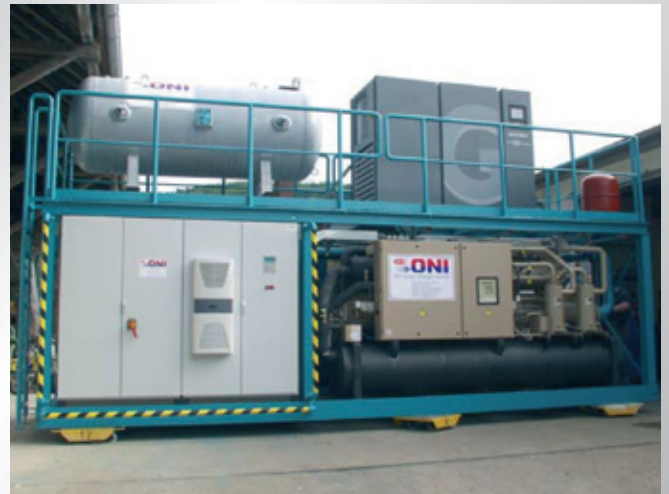
Power-Tower Kälte-/Druckluftanlage für ein Projekt in China Power-Tower chilling/compressed-air system for a project in China
