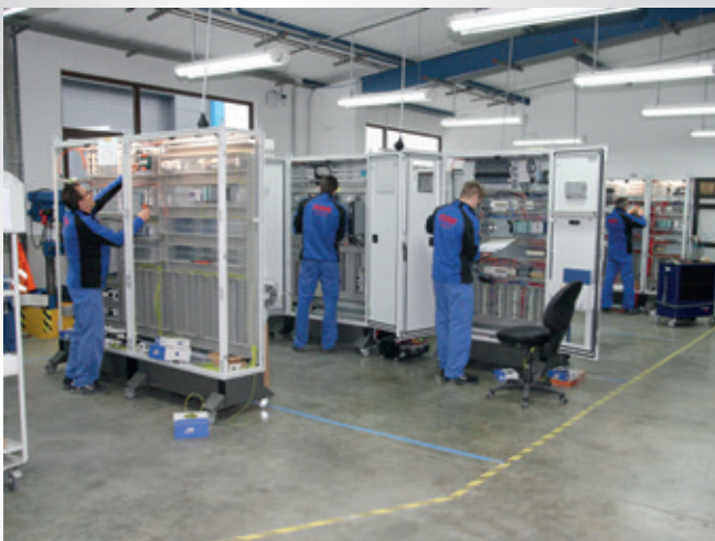
Blick in einen Teilbereich der ONI-Schaltschrankfertigung View of a partial area of ONI switchgear cabinet production
