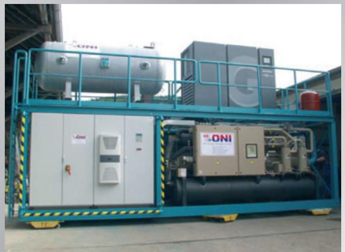
Power-Tower Kälte-/Druckluftanlage für ein Projekt in China
