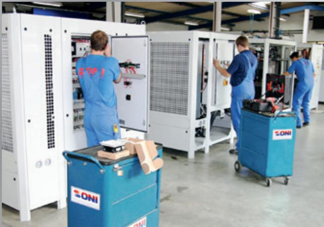
Luftgekühlte Kompakt-Kältemaschine in der Endmontage
