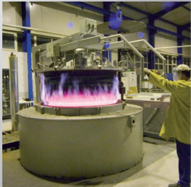
Ein Induktionshärteofen wird geöffnet. Die für den Betrieb erforderliche Kühlanlage kommt aus dem Hause ONI.
